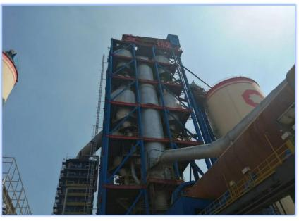
第三代篦冷机改为第四代篦冷机 标煤耗下降1-2kg/t.cl A线窑系统提产节能技改项目 系统标煤耗下降3-6kg/t.cl
