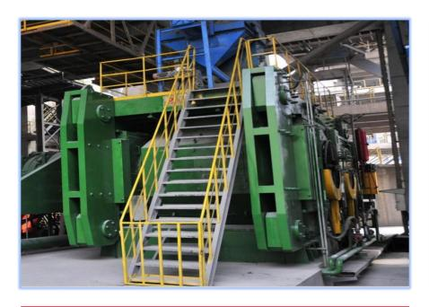
立磨改辊压机技术改造降低生料工序电耗5-7度
